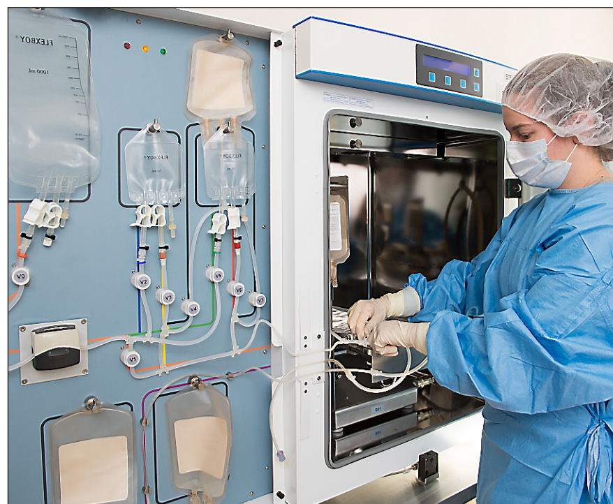
► L'automate de la biotech française Cellprothera dans lequel les cellules-souches sont démultipliées et mélangées à la substance médicamenteuse. Photo Cellprothera
